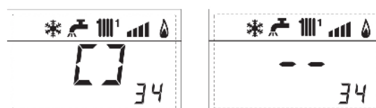
32. zobrazení relé R2 na solárním okruhu (INSOL)
