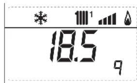
10. zobrazení provozních hodin hořáku x100 (10 a 14000)
