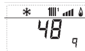
10. zobrazení provozních hodin hořáku x100 (10 a 14000)
