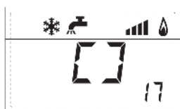
19. zobrazení stavu havarijního termostatu zony 1 (ON,OFF)
