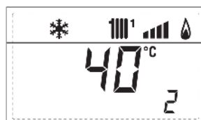
3. teplota TUV – NTC čidlo (SS)
