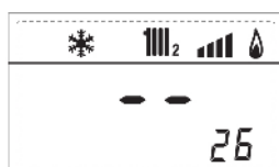
24. zobrazení stavu havarijního termostatu zony 2 (ON,OFF)
